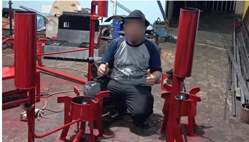
Gambar 4.3 Pembuatan Kompor Ramah Lingkungan Berbahan Bakar Oli Bekas
