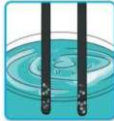
Gambar 1.21 Garpu tala yang bergetar dimasukkan ke dalam air.
